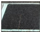
《赤外線カメラによるアスファルト舗装の表面温度 2006年8月4日 PM0:07 気温36℃》
