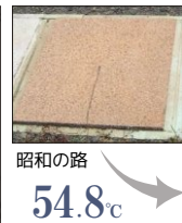
《赤外線カメラによるアスファルト舗装の表面温度 2006年8月4日 PM0:07 気温36℃》
